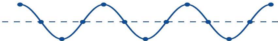
Рисунок 2. Поперечные волны на струне
