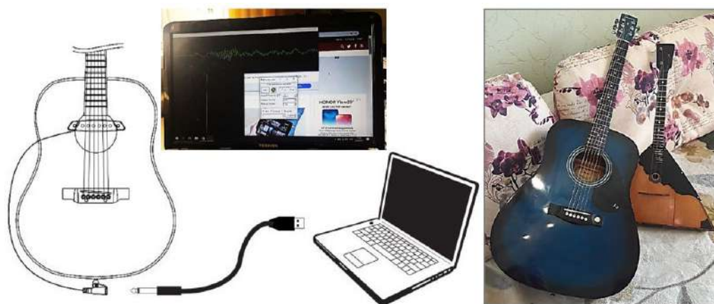
Рисунок 4. Подключение гитары к компьютеру с помощью пьезодатчика и запись колебания струн с помощью компьютерной программы
